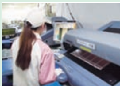
▲コンピュータを使い、 基板のパターンをひとつひとつチェック
