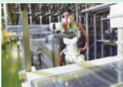
▲ロボットアームによる 銅めっきの受け取り
